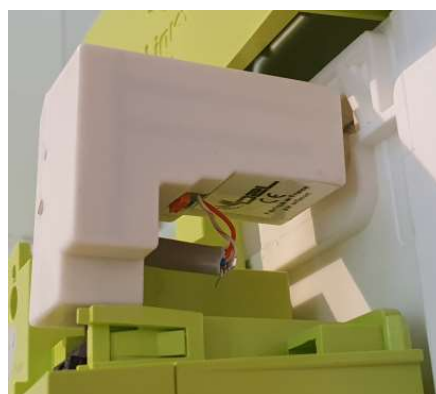
Exemple de module ERL avec déport TIC installé et câblé
