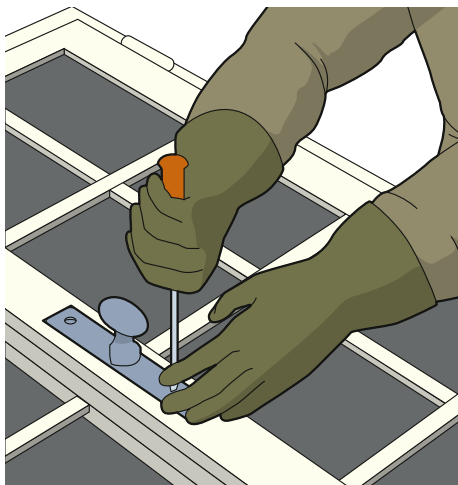
8 Repose éventuelle de la quincaillerie et du vitrage
