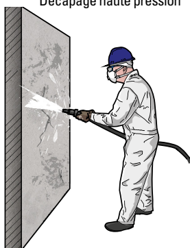
Décapage haute pression
